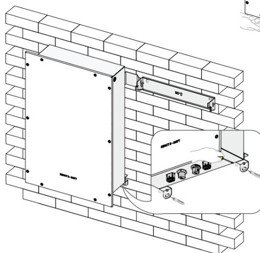
La procedura riportata di seguito è riferita all'installazione affiancate del REACT2-BATT. In alternativa, è possibile installare il REACT2-BATT separatamente e distanziato utilizzando i cavi contenuti nel "REACT2-XL-CABLE-KIT" (lunghezza dei cavi di 2 metri).
