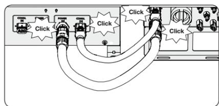
Collegare i due cavi batteria tra inverter e unità batteria (forniti all'interno del box del REACT2-BATT).
