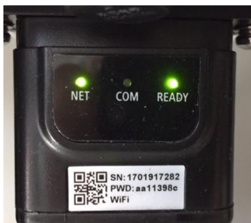
Figura 68 - Stato di comunicazione irregolare tra inverter e adattatore
