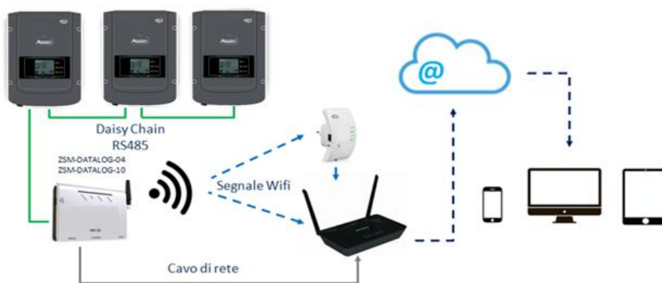
Figura 76 – Schema per il collegamento del datalogger ZSM-DATALOG-04 / ZSM-DATALOG-10
