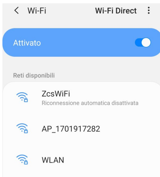
Figura 45 - Disabilitazione della riconnessione automatica a una rete
