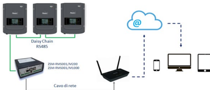
Figura 81 - Schema che mostra il funzionamento del datalogger ZSM-RMS001/M200 / ZSM-RMS001/M1000
