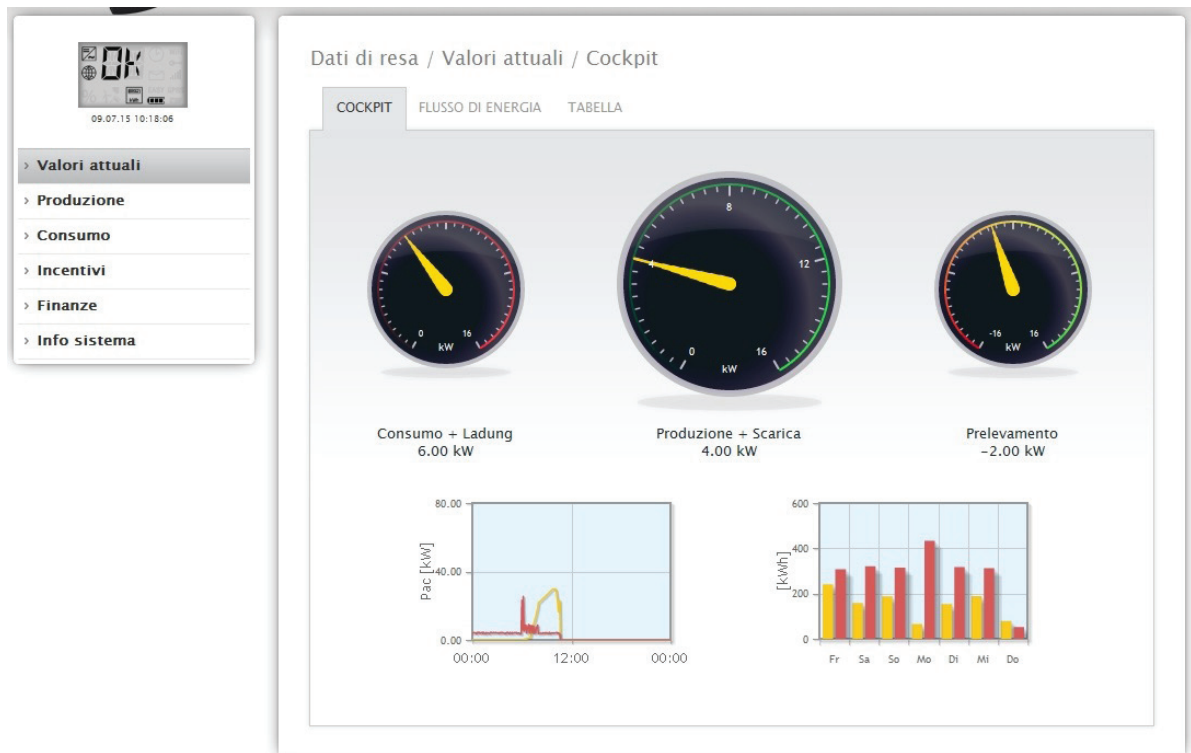
Fig.: Valori attuali dell'impianto (vista Cockpit)
