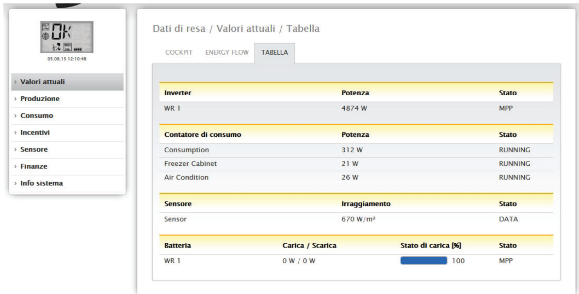
Fig.: Registrazione della potenza di un impianto esemplificativo sotto forma di tabella
