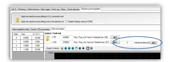
Per il modello di inverter PRO-33.0-TL-OUTD tale funzione viene abilitata da display (124.45 Q(U) activation delay):
