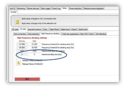
Per il modello di inverter PRO-33.0-TL-OUTD tale funzione viene abilitata da display (130.69 P(f) activation delay):
