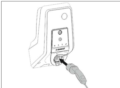
Fig.: 21. Brancher le câble de charge
