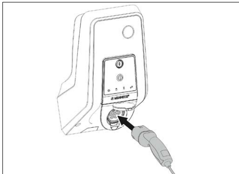
Bild: 21. Sätta i laddkabeln
