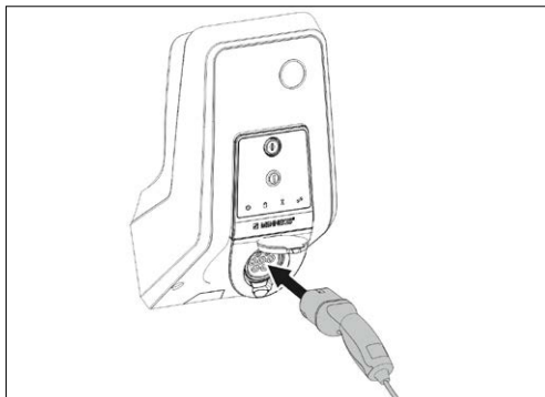
Fig.: 21. Inserire il cavo di ricarica
