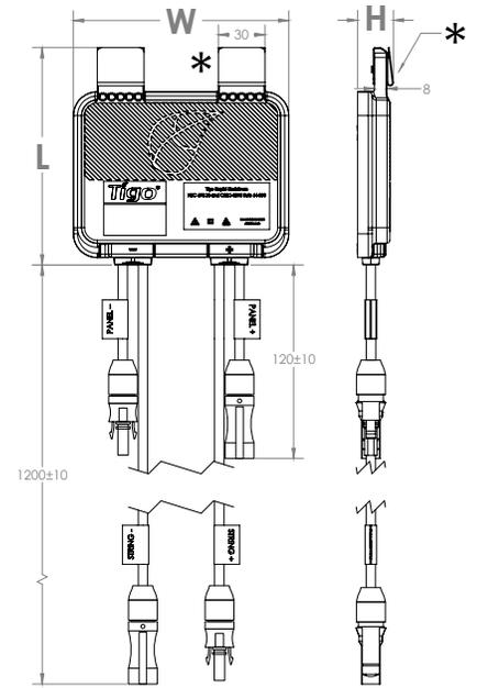
\*Clip rimuovibili per montaggio su struttura
