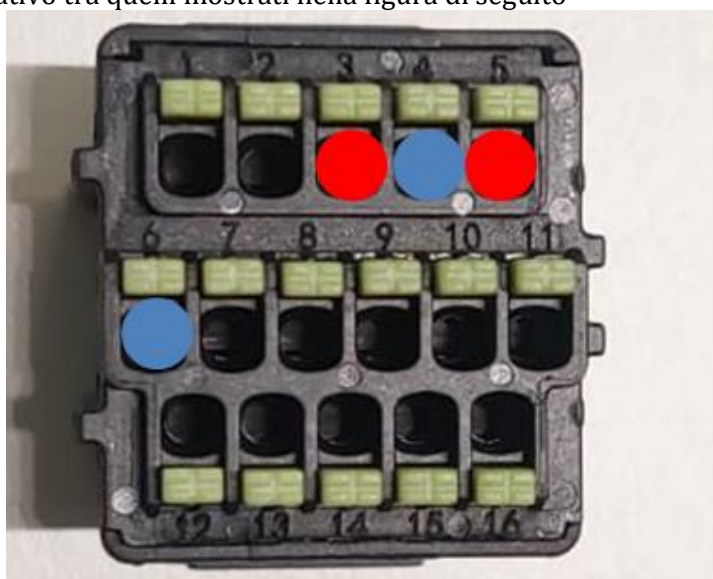
Figura 4 - Collegamento della linea seriale tramite connettore di comunicazione per 3PH HYD5000-HYD20000-ZSS
