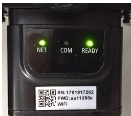
Figura 63 - Stato di comunicazione irregolare tra inverter e adattatore
