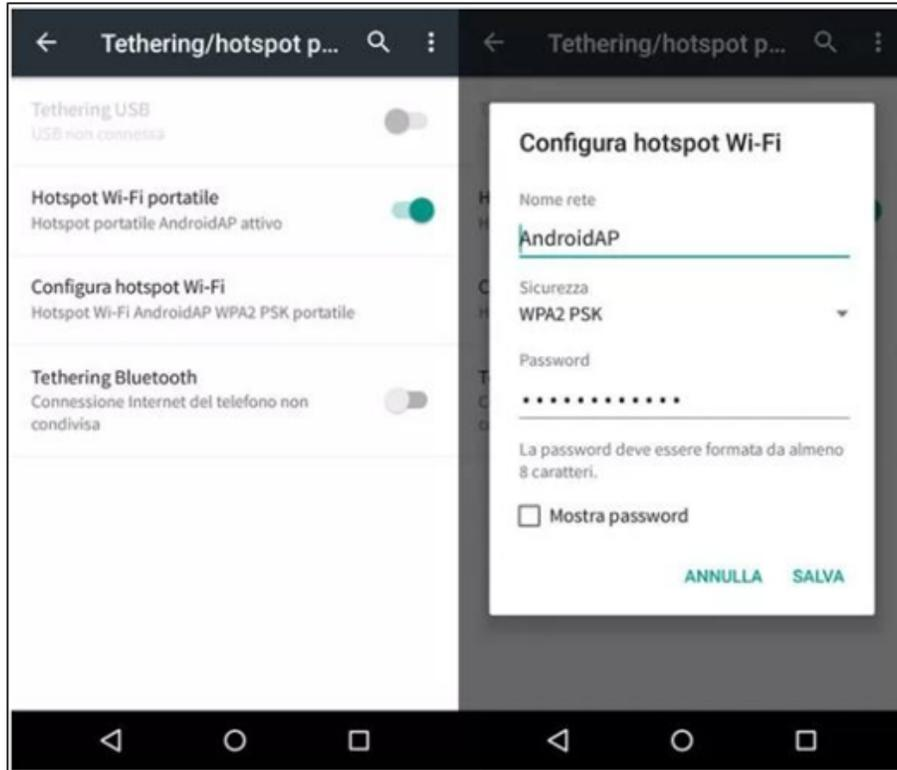
Figura 96 – Configurazione dello smartphone Android come router hotspot
