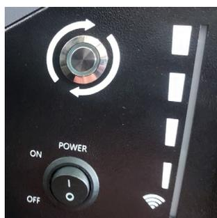
7. Impostare tutte le batterie, tramite interruttore laterale su 1 senza accenderle (non premere pulsante rotondo metallico), accendere la SOLA batteria master premendo il pulsante fino a quando non si retroillumina il led. Le batterie si accenderanno automaticamente a cascata (ogni modulo si accenderà automaticamente ed il pulsante laterale lampeggerà per 3 secondi, quindi una luce VERDE fissa confermerà lo stato di accensione di ciascun modulo).
