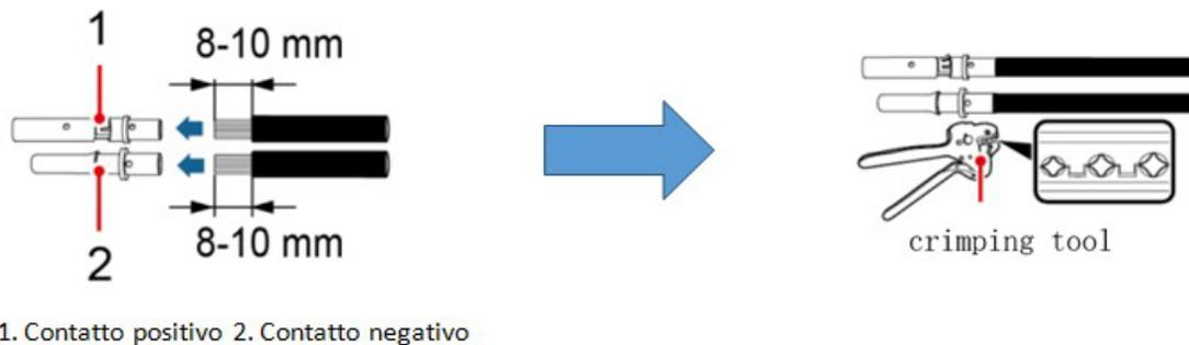
Figura 52 - Preparazione dei cavi fotovoltaici positivi e negativi
