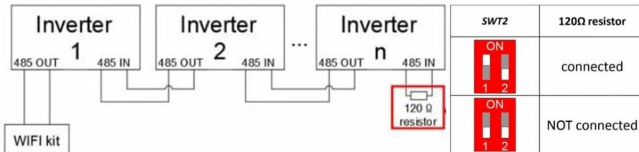
Figura 107 - Posizione dei dip switch per collegare la resistenza di isolamento
