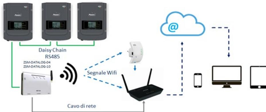
Figura 112 – Schema di connessione del datalogger ZSM-DATALOG-04 / ZSM-DATALOG-10
