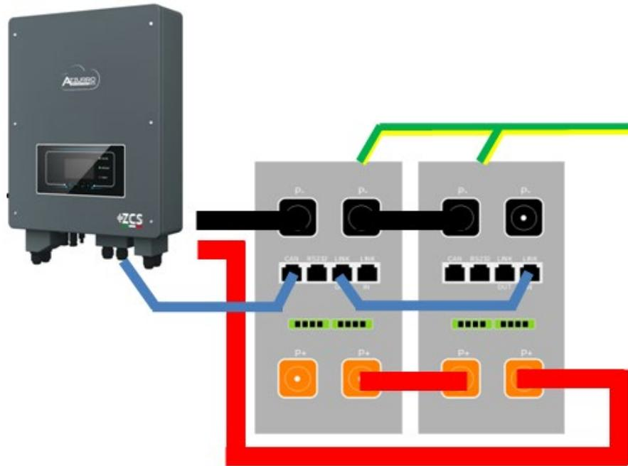
Figura 49 - Parallelo di due batterie AZZURRO 5000 PRO
