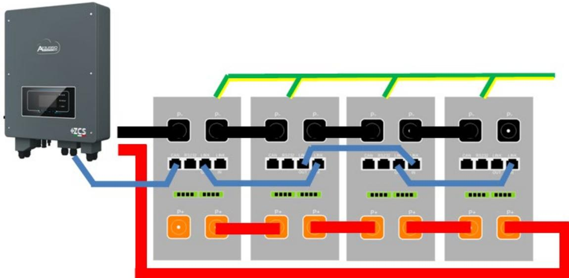
Figura 51 - Parallelo di quattro batterie AZZURRO ZSX 5120
