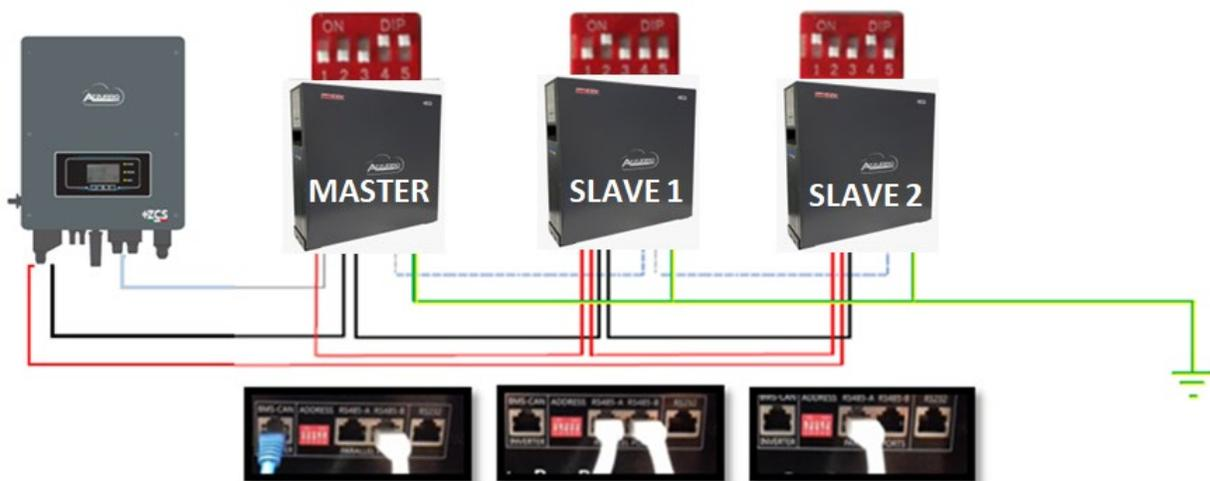
Figura 16 – Parallelo di tre batterie WeCo 4k4
