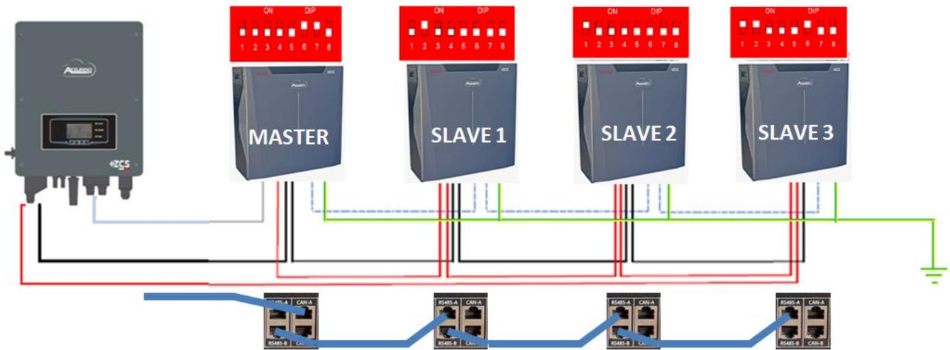
Figura 31 - Parallelo di quattro batterie WeCo 5k3
