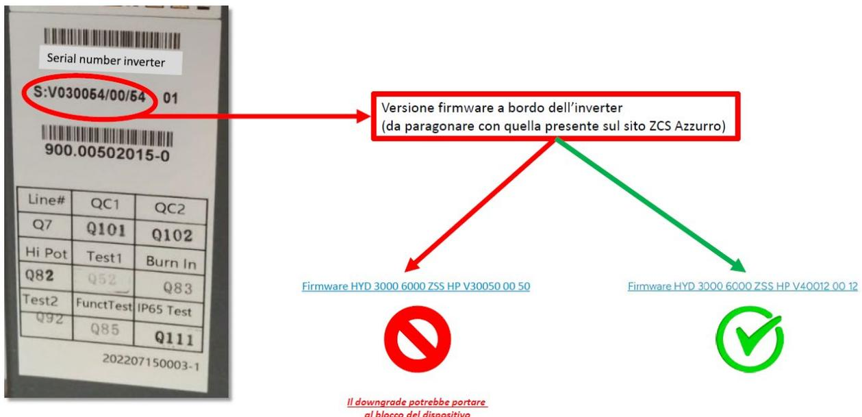
**ATTENZIONE!! Il downgrade della versione firmware dell’inverter potrebbe portare al guasto del dispositivo.**
