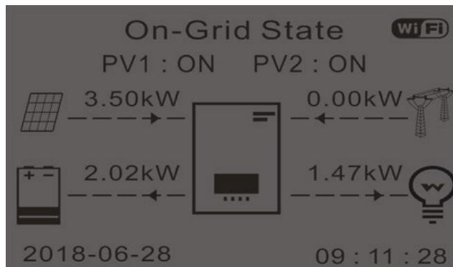
8. Se le precedenti non sono verificate controllare il posizionamento dei TA e il direzionamento consultando le procedure di corretta installazione e primo avvio.
