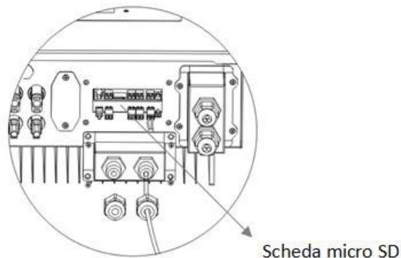
**Fase 2** Premere la scheda SD e rimuoverla. Inserire la scheda SD all'interno del lettore micro-SD, quindi inserirlo nel PC; (NOTA: il lettore micro-SD e il PC non vengono forniti da ZCS).
