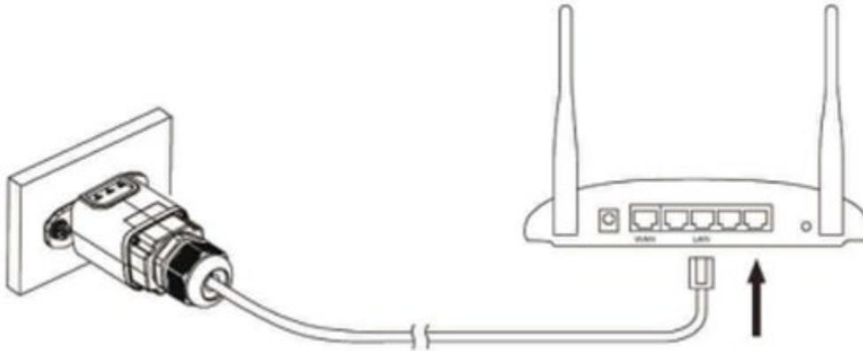
Figura 101 - Collegamento del cavo di rete al modem
