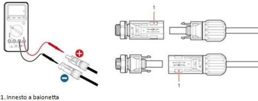
Figura 54 - Collegamento dei connettori fotovoltaici
