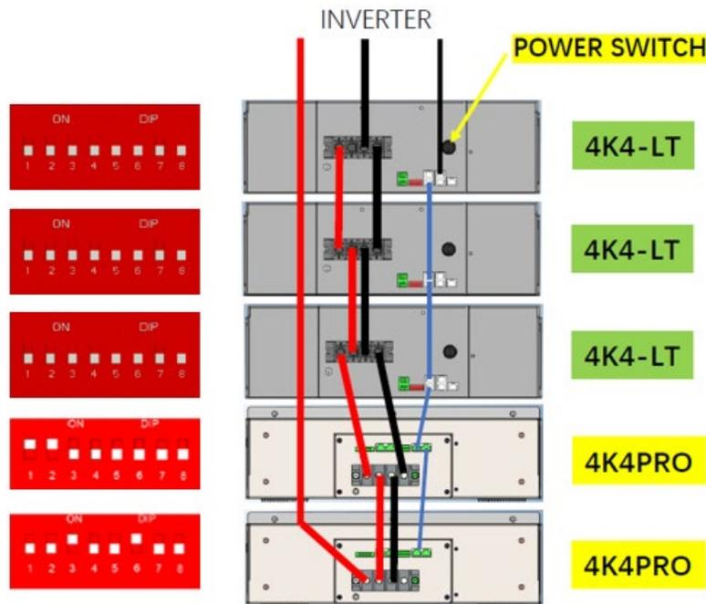
Figura 7 – Collegamento in BATTERIE Weco 4k4-LT e 4k4 PRO
