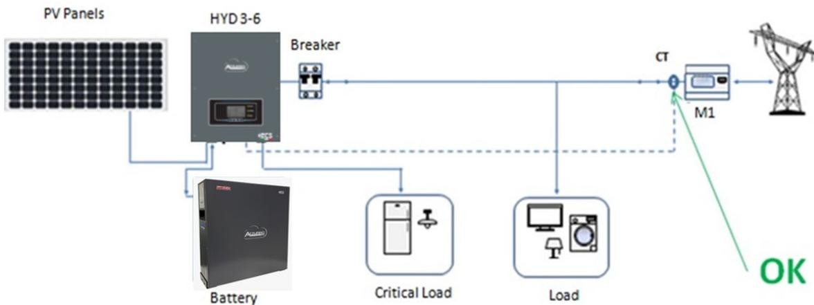
Figura 61 - Posizionamento corretto delle sonde di corrente
