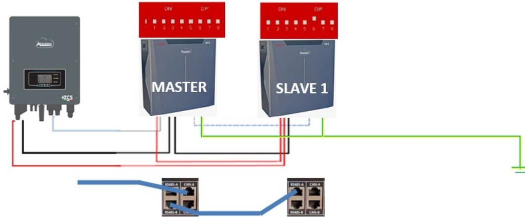
Figura 36 - Collegamento in parallelo di due batterie WeCo 5K3XP
