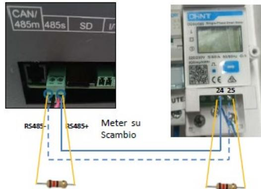
5. Collegare il Meter nella modalità «inserzione diretta» nel dettaglio:
