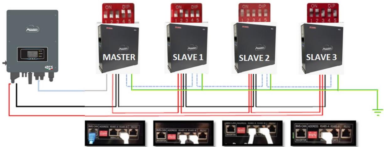
Figura 17 - Parallelo di quattro batterie WeCo 4k4
