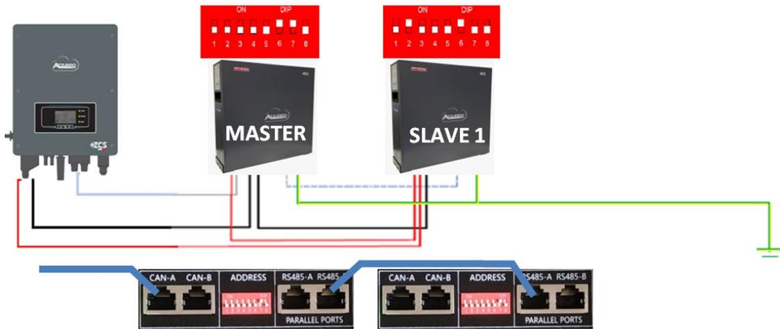
Figura 22 – Parallelo di due batterie WeCo 4k4 PRO
