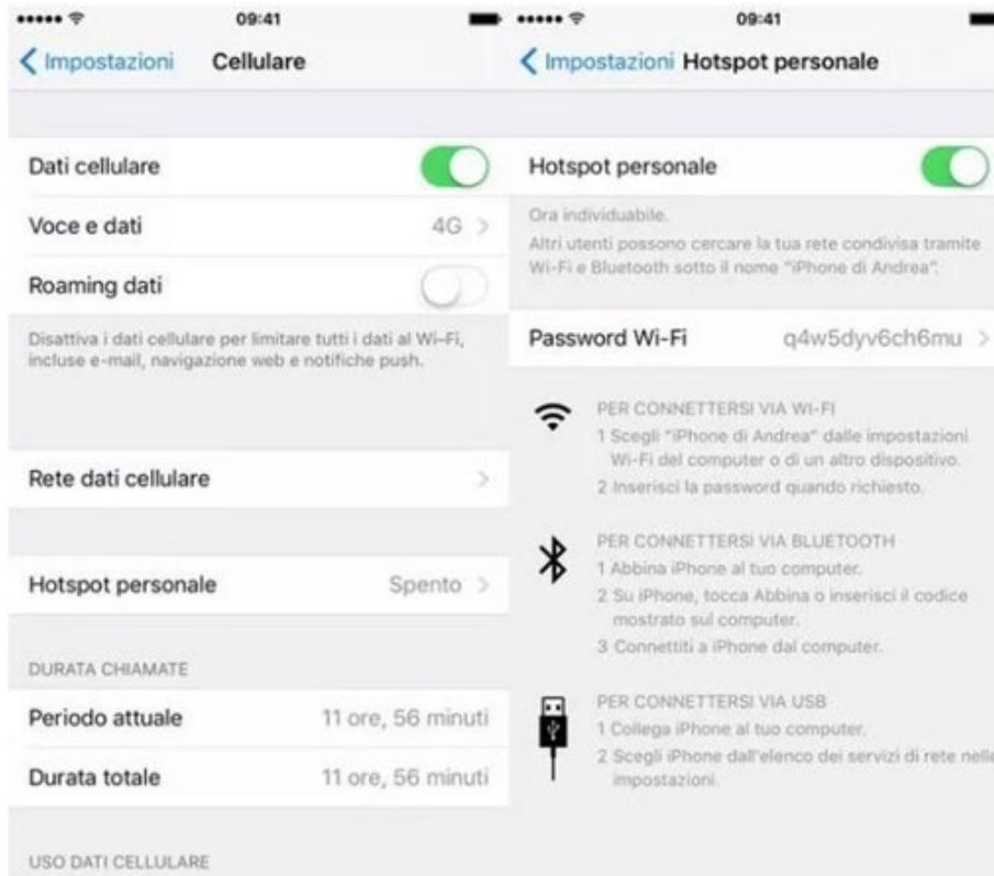
Figura 97 - Configurazione dello smartphone iOS come router hotspot
