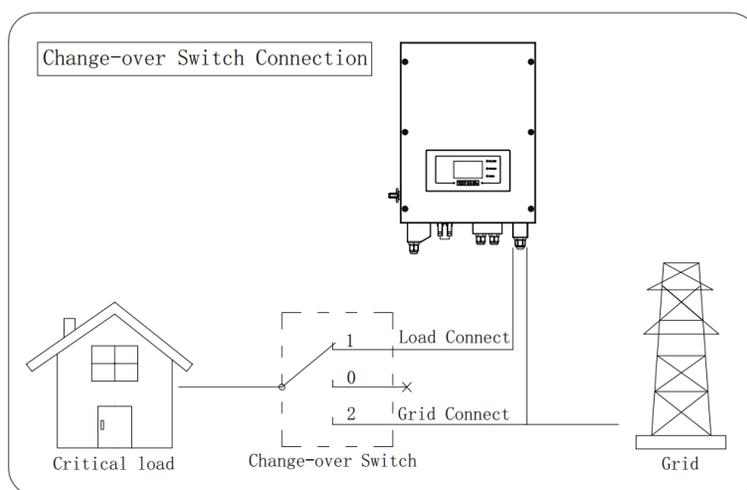
Figura 65 – Collegamenti commutatore
