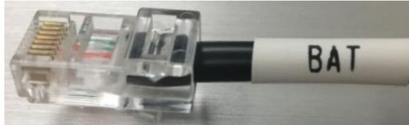
Figura 1- Cavo di comunicazione Pylontech da inserire nell'ingresso comunicazione batteria
