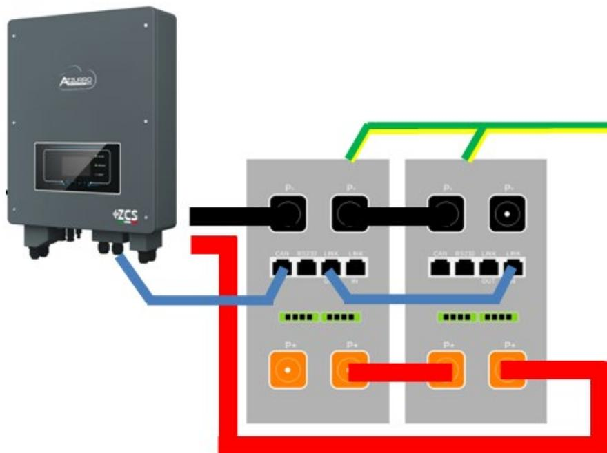
Figura 49 - Parallelo di due batterie AZZURRO ZSX 5120
