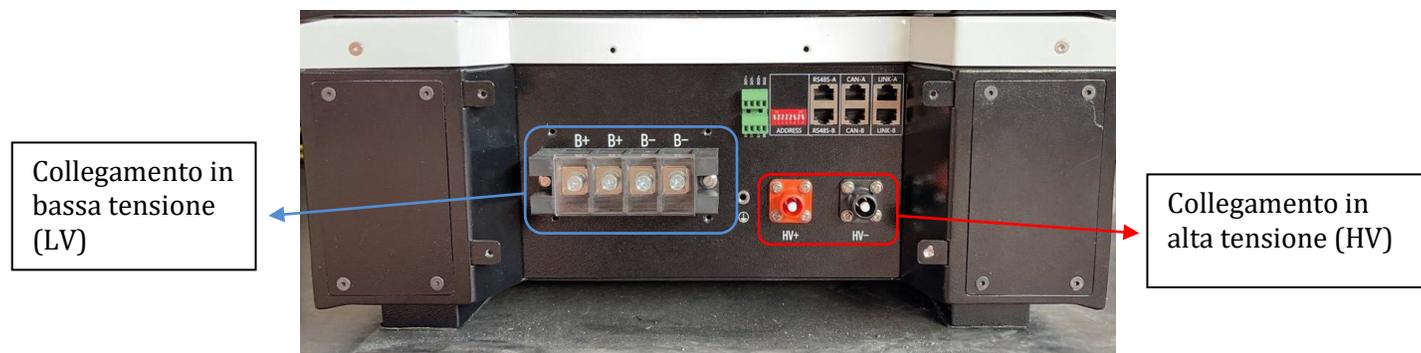
**Attenzione:** Per il collegamento delle batterie 5k3 con inverter 3000SP o ibrido monofase è obbligatorio utilizzare la sola sezione in bassa tensione. Non utilizzare la sezione in alta tensione onde evitare danneggiamenti di batterie o inverter.
