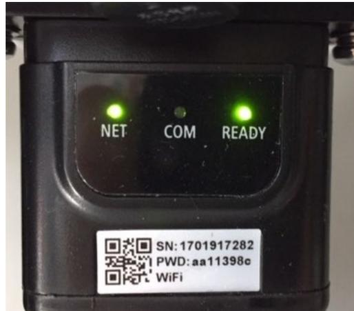
Figura 103 - Stato di comunicazione irregolare tra inverter e scheda
