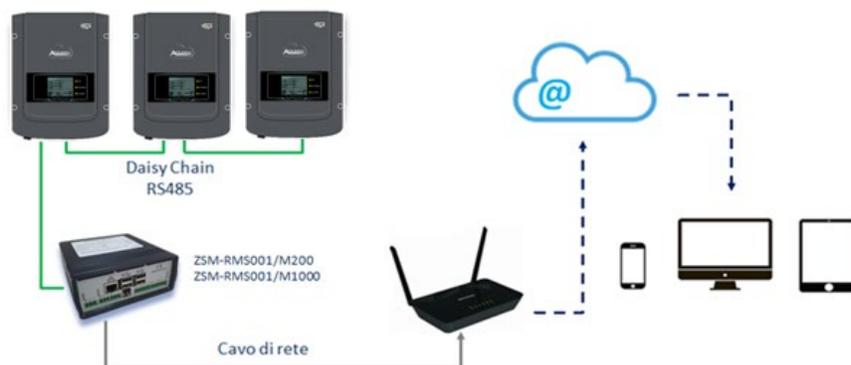
Figura 113 – Schema di funzionamento del datalogger ZSM-RMS001/M200 / ZSM-RMS001/M1000
