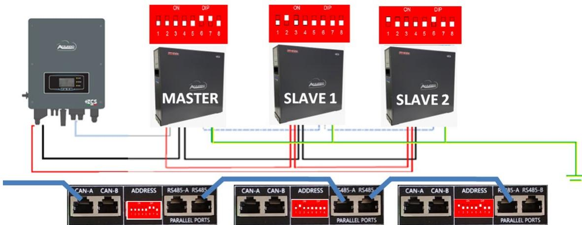
Figura 23 – Parallelo di tre batterie WeCo 4k4 PRO
