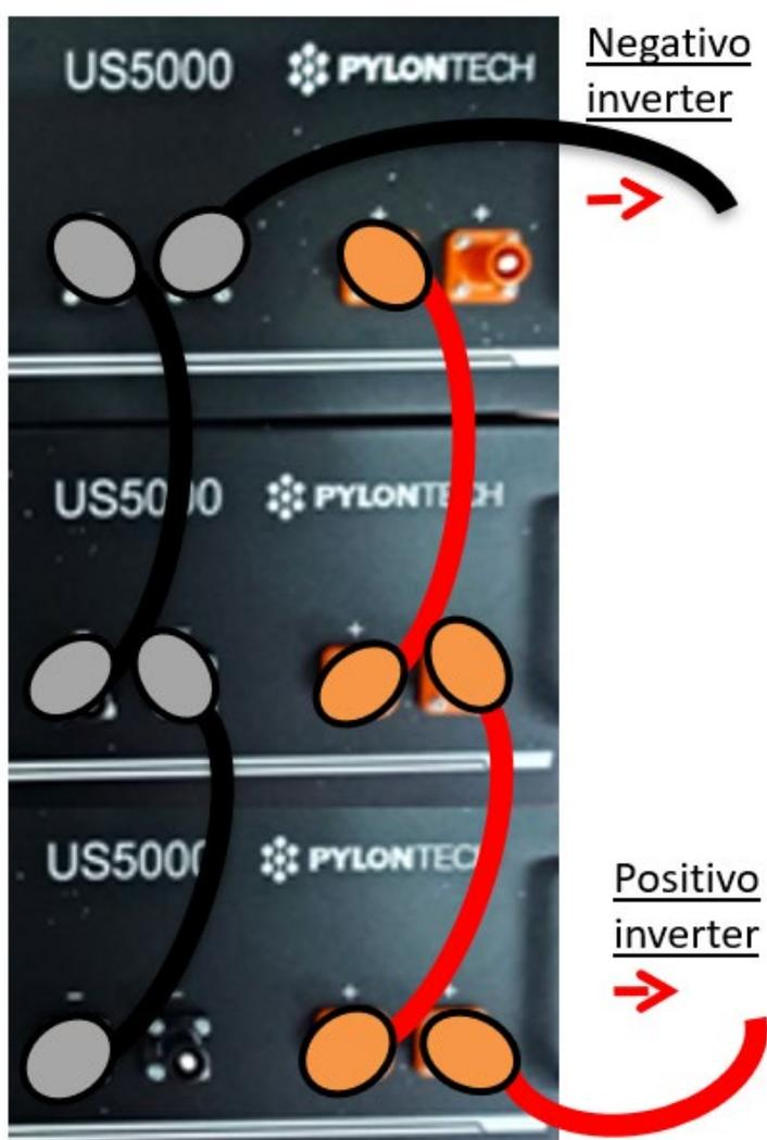
Figura 50 – Parallelo di tre batterie Pylontech
