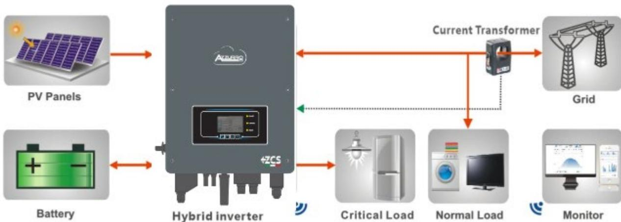
Figura 1 - Diagramma schematico di un impianto su cui è installato un inverter ibrido 1PH HYD3000-HYD6000-ZSS
