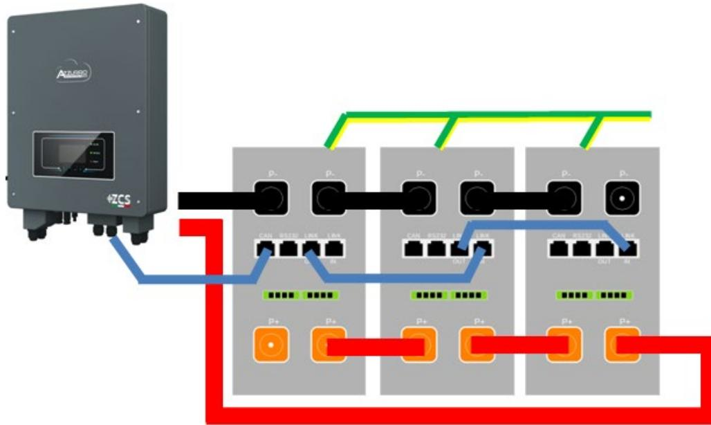
Figura 50 - Parallelo di tre batterie AZZURRO ZSX 5120
