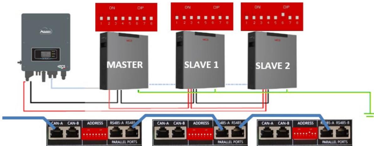
Figura 26 - Parallelo di tre batterie WeCo 4k4-LT
