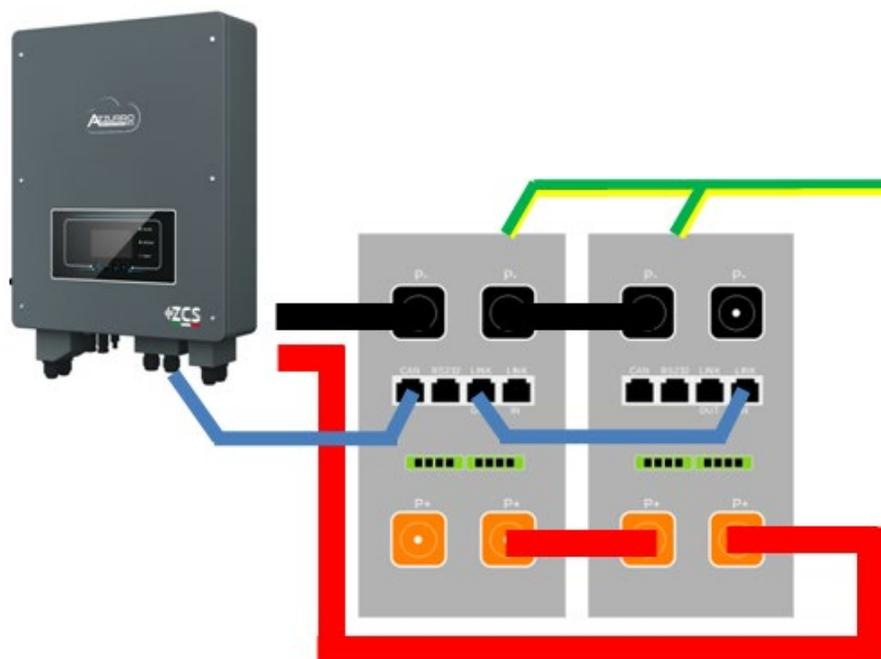
Figura 49 – Parallelo di due batterie AZZURRO 5000
