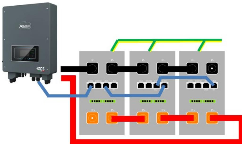
Figura 50 – Parallelo di tre batterie AZZURRO 5000
