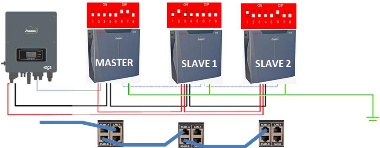
Figura 30 - Parallelo di tre batterie WeCo 5k3
