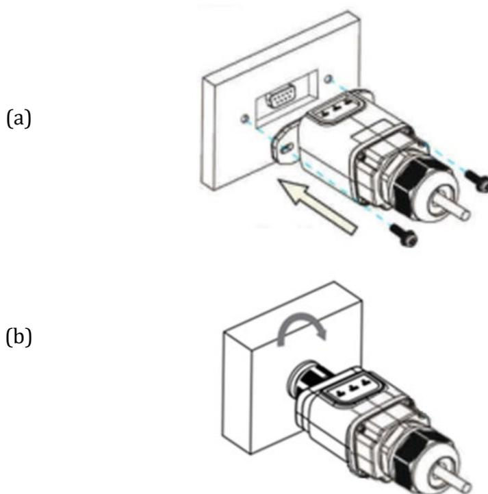
Figura 100 - Inserimento e fissaggio della scheda ethernet
