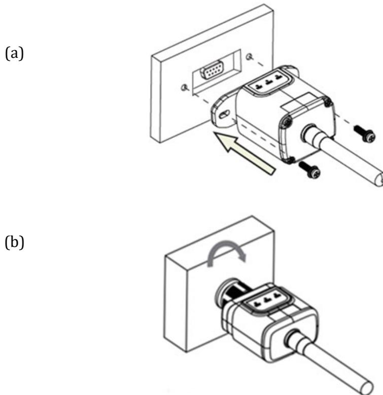
Figura 107 - Inserimento e fissaggio della scheda 4G
