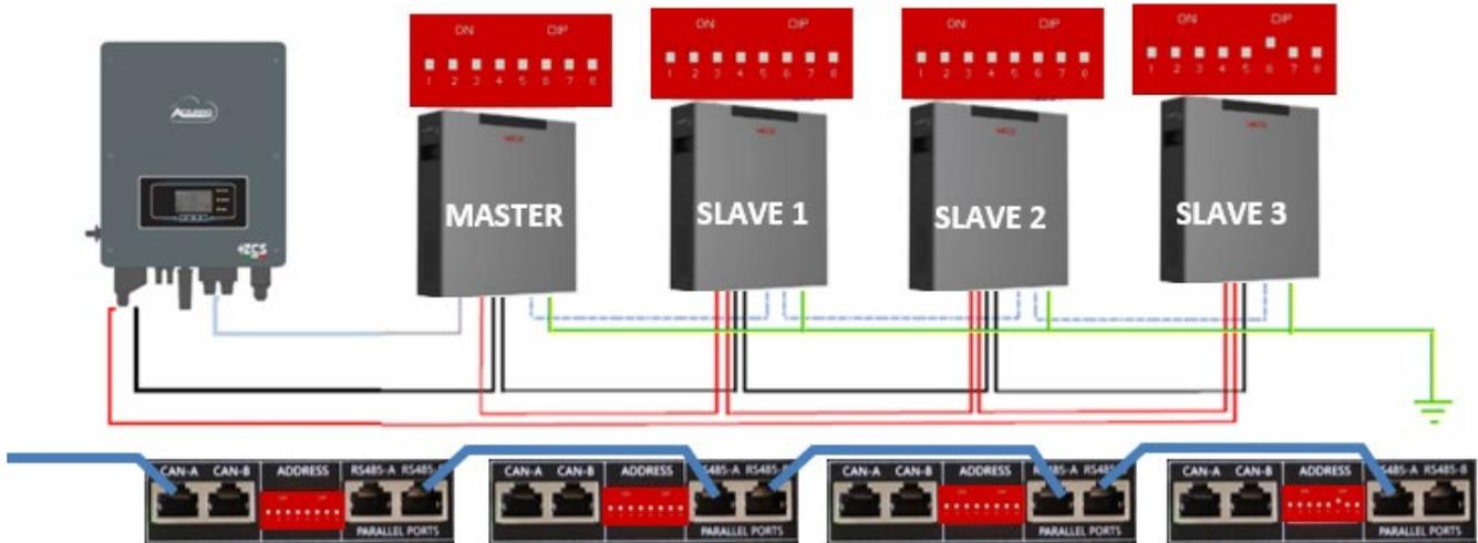
Figura 27 - Parallelo di quattro batterie WeCo 4k4-LT
