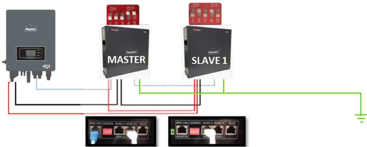
Figura 15 – Parallelo di due batterie WeCo 4k4
